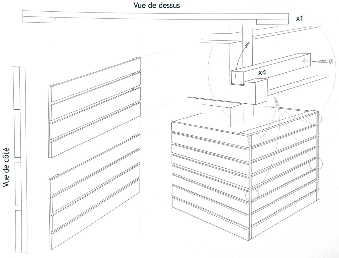
La façade est réalisée en deux parties. Ceci permet une utilisation facile du composteur lors des interventions d'aération, de vidange...
